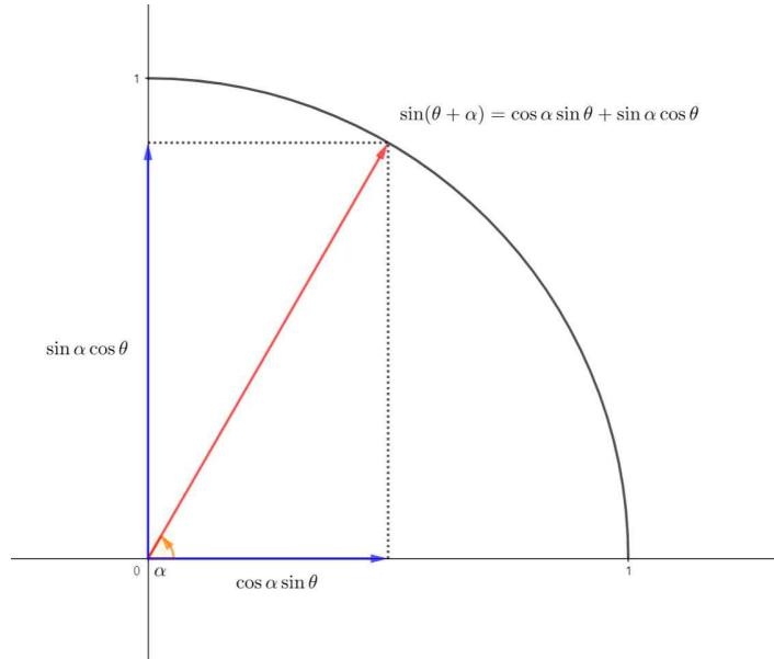
그림과 같은 단위원에서  $\sin(\theta+\alpha)$ 는  $\sin\theta$ 축에서 길이 1인 위상자가 각도  $\alpha$ 만큼 회전한 것이다. 따라서 위상자의 종점에서  $\sin$ 축,  $\cos$ 축에 각각 수선의 발을 내리면 원점을 시점으로 하고 두 수선의 발을 종점으로 하는 두 위상자의 길이는 각각  $\cos\alpha$ ,  $\sin\alpha$ 이다. 즉 처음의  $\sin(\theta+\alpha)$  위상자(빨간색)를  $\sin$ 축 성분과  $\cos$ 축 성분의 두 위상자(파란색)로 분해할 수 있고 이들의 길이는 각각  $\cos\alpha$ ,  $\sin\alpha$ 이므로,  $\sin(\theta+\alpha) = \cos\alpha\sin\theta + \sin\alpha\cos\theta$ 가 성립한다.
